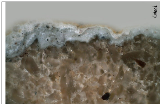
Nábrus, mikrofoto v bílém odraženém světle, nábrus, fotografováno při zvětšení 100x
