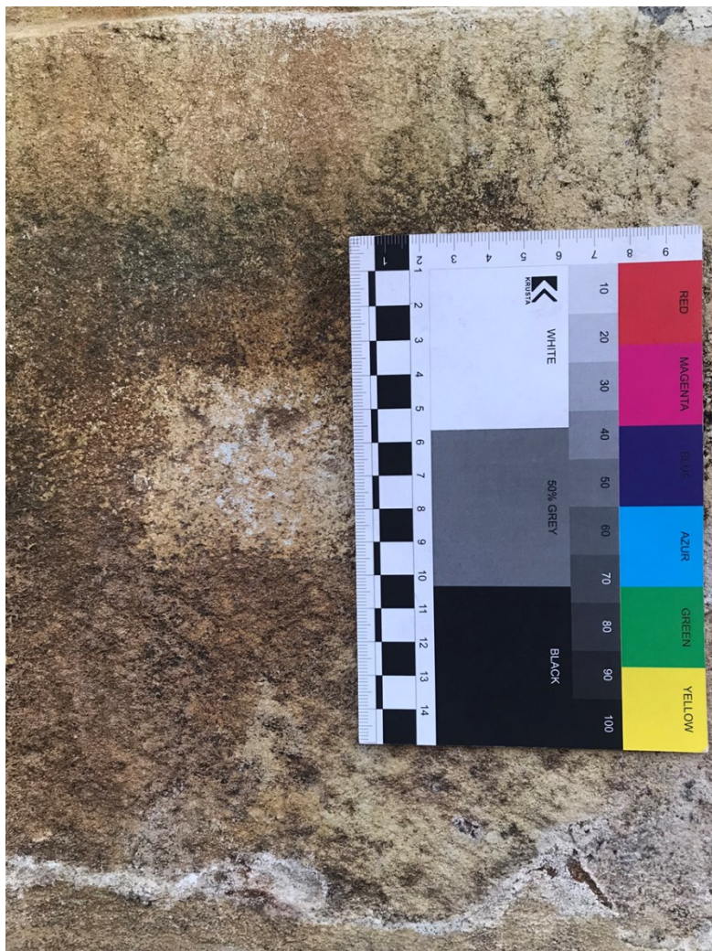
Obr. 1 Zkouška odstranění biologického povlaku mechanicky pomocí silonového kartáčku
