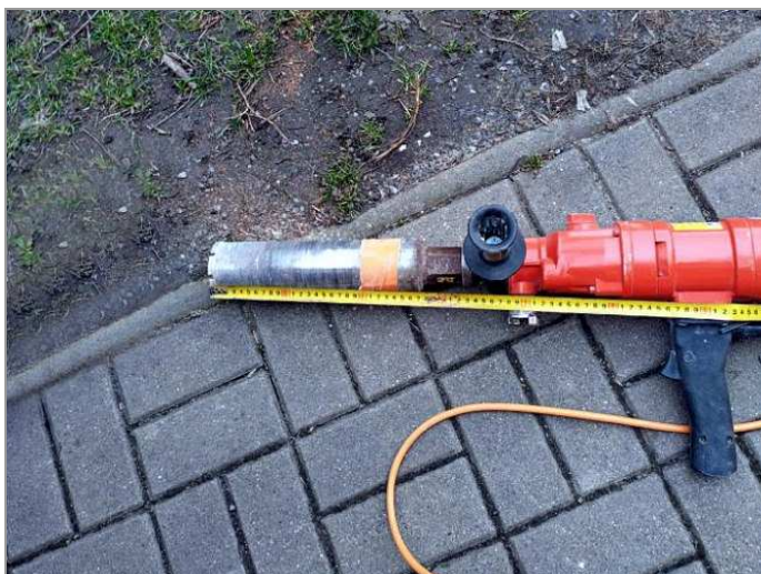
foto 20: Vrtná souprava pro realizaci jádrových vývrtů z fasády
