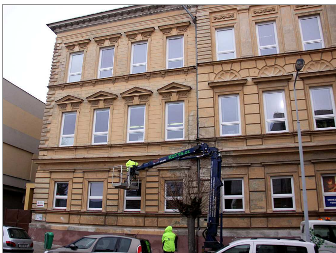
foto 18, 19: Realizace zkoušek přídržnosti omítky z vysokozdvíže plošiny
