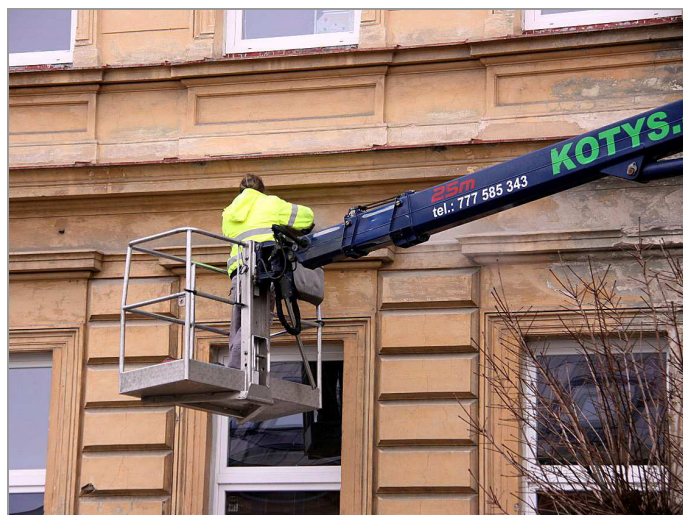
foto 18, 19: Realizace zkoušek přídržnosti omítky z vysokozdvíže plošiny
