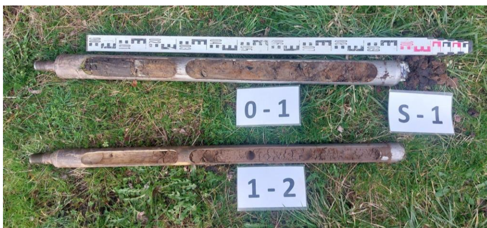
Obr. 2 Zastižené zeminy sondou S-1 v úrovni 0,00 – 2,00 m p. t.
