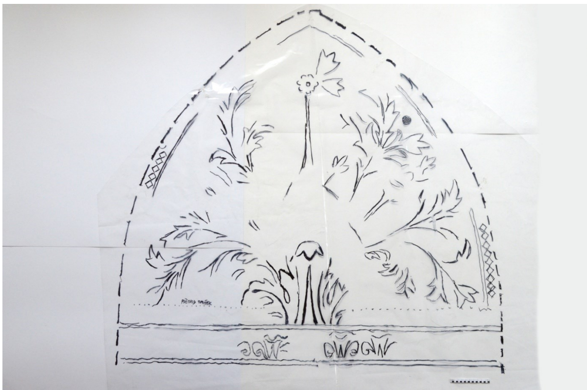
Obr. 22 Pauza akantového dekoru v horní části niky. Vzhledem k pokročilé fázi rozpadu navrhujeme jeho rekonstrukci na nový omítkový podklad. Předtím bude na tomto základě a analogických dekorech proveden kresebný návrh rekonstrukce.
