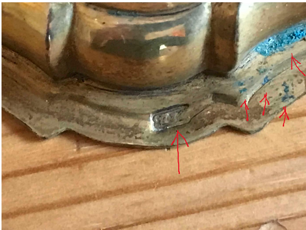
Puncovní značka a masivní vrstva oxidace v ohybu lemu patky.
