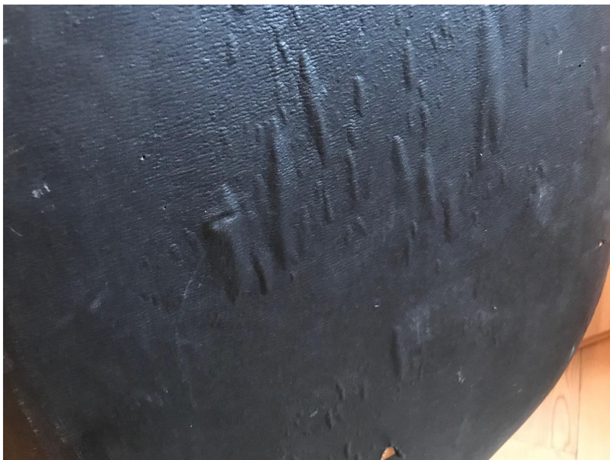
Uvolněný kožený potah od dřevěné konstrukce etue.
