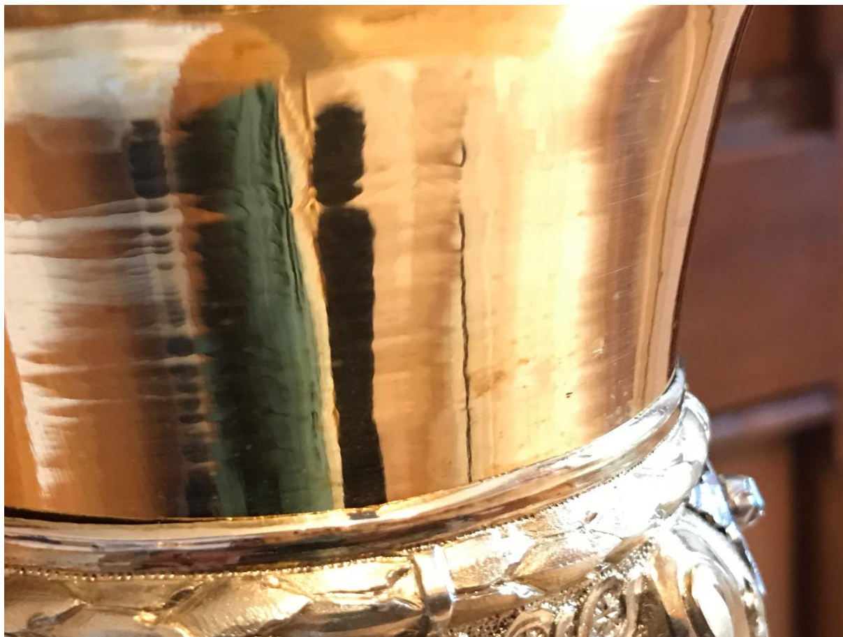
Stav zlacení povrchu kupy – drobné stopy oxidace ve formě ztmavlého povrchu.
