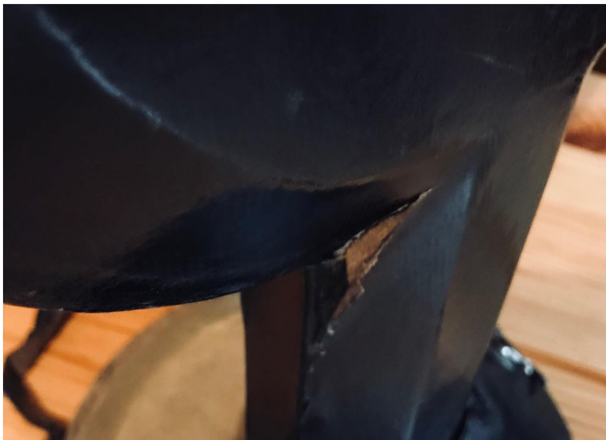
Odtržený povrch etue v místě vrcholu nodu.
