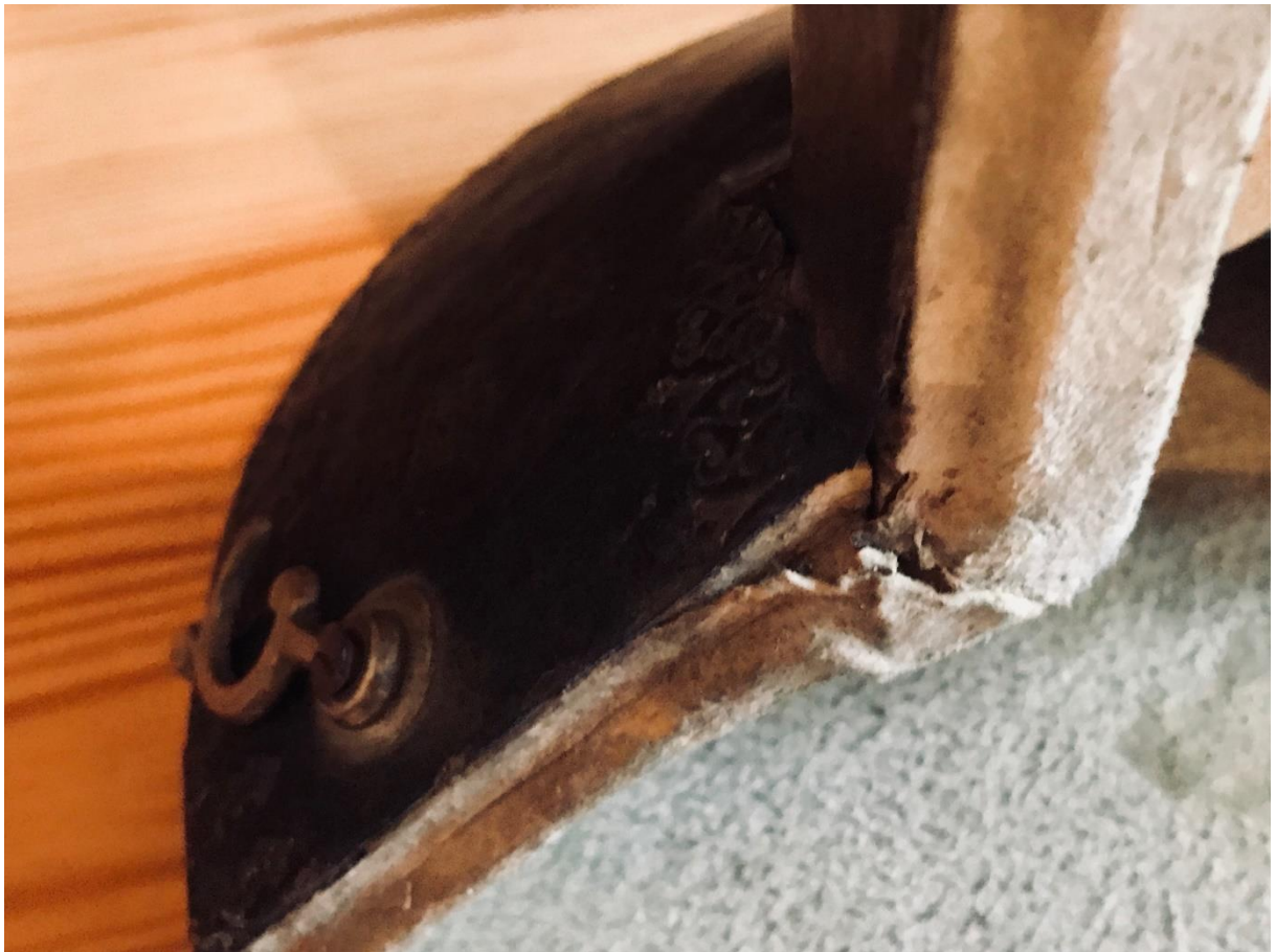
Poškození stélky v místě zlomu konstrukce etue - levá strana.
