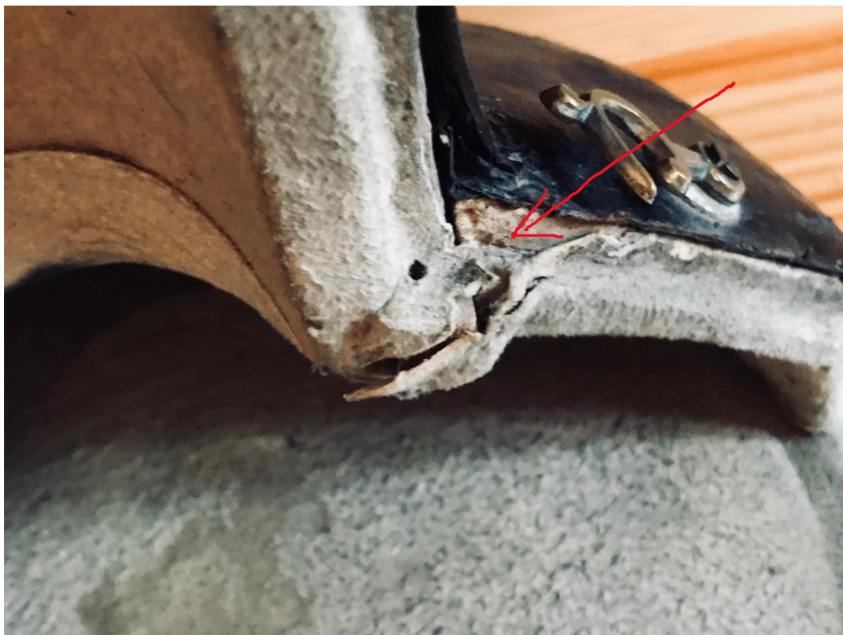
Poškození stélky v místě zlomu konstrukce etue - pravá strana.
