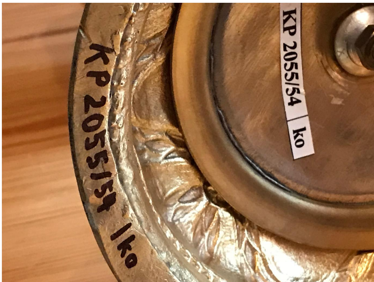
Stav postříbření povrchu spodní části patky.
