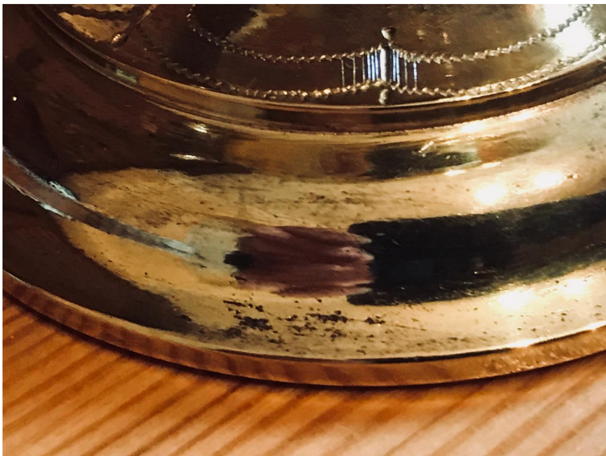
Oxidace zlaceného povrchu patky konvičky.
