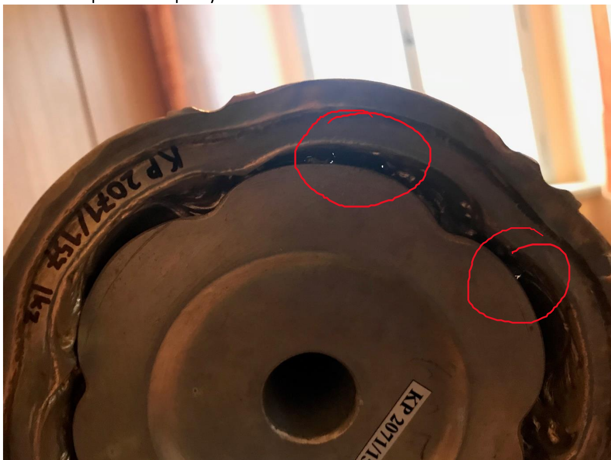
Prosvítající praskliny tepaného reliéfu patky kalicha.
