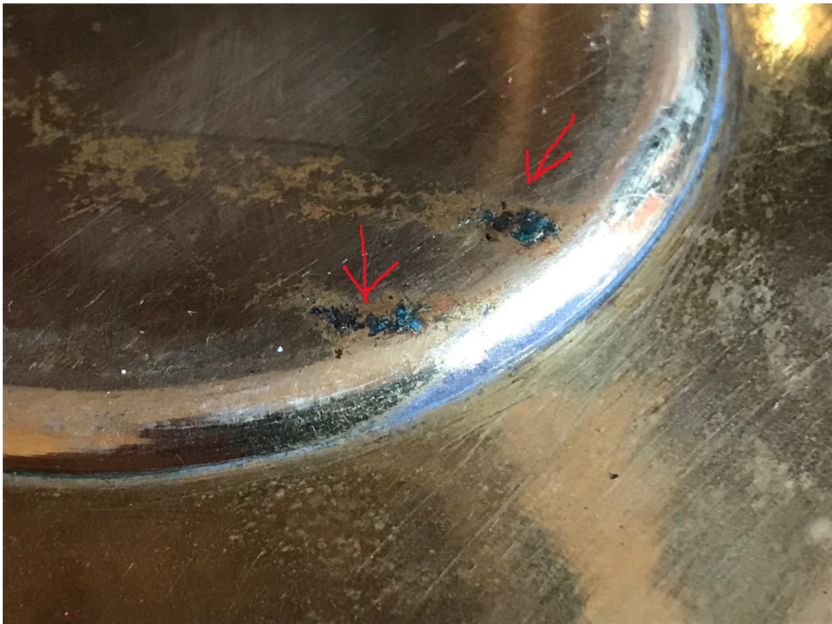
Oxidace Mosazného plechu prostupující zlaceným povrchem.
