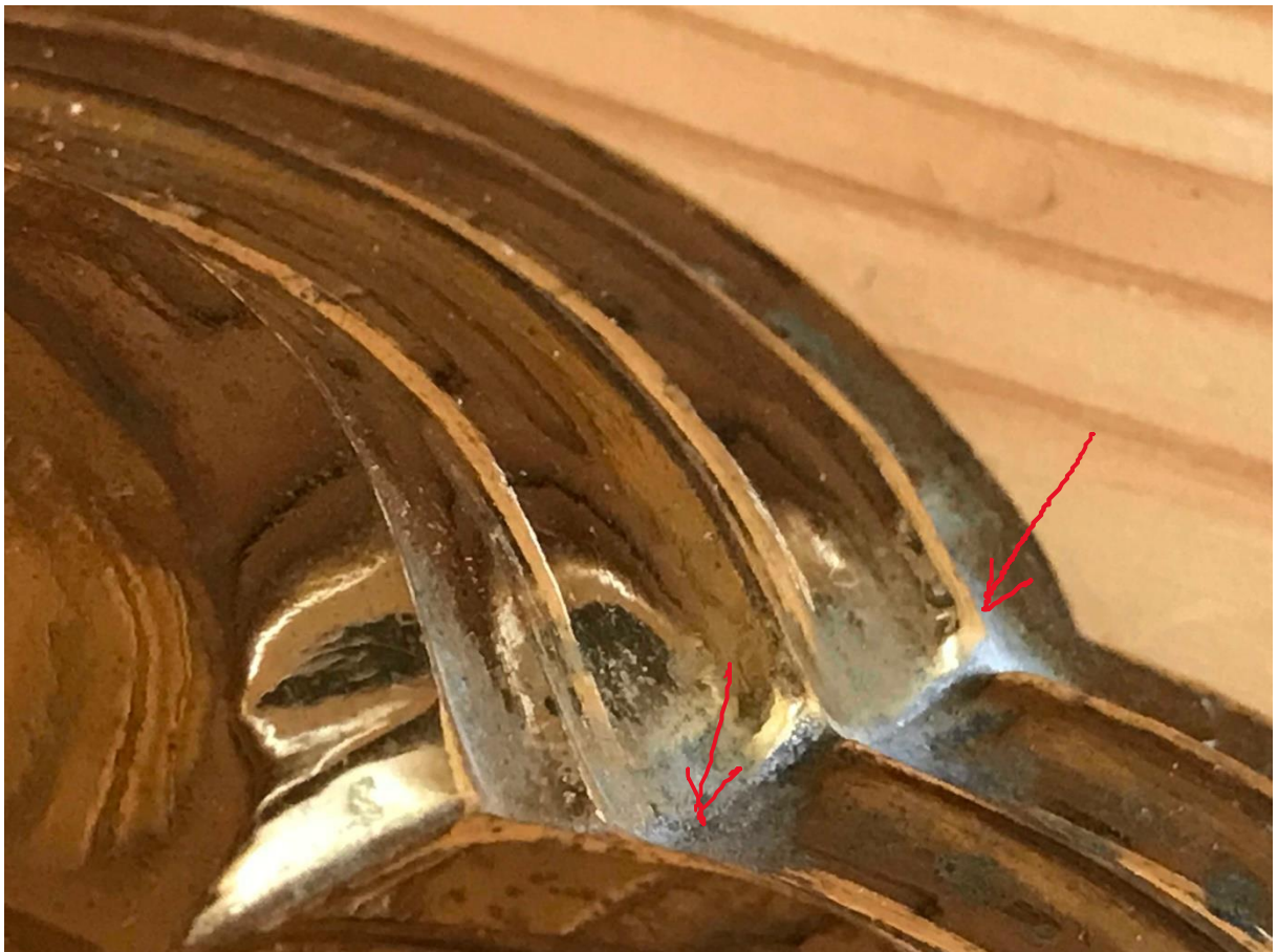
Prach, nečistoty a oxidace. (patka kalicha)
