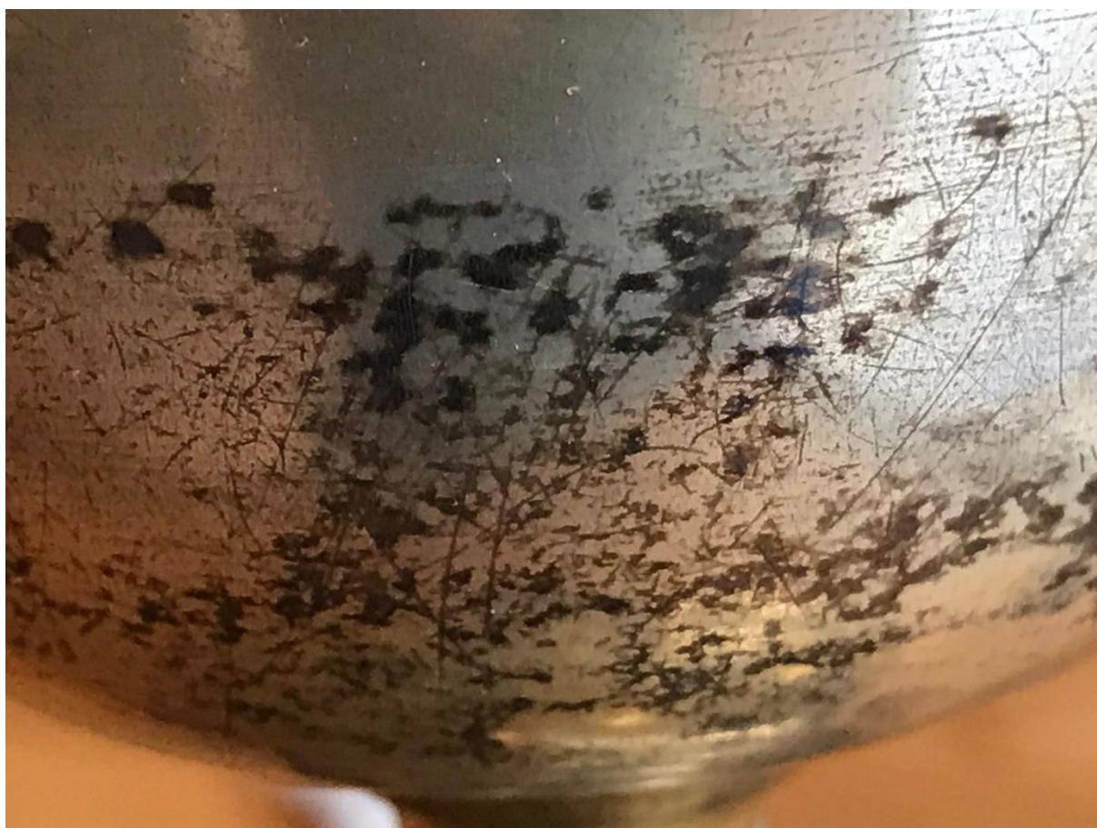
Oxidace povrchu zlacení na povrchu stříbra.
