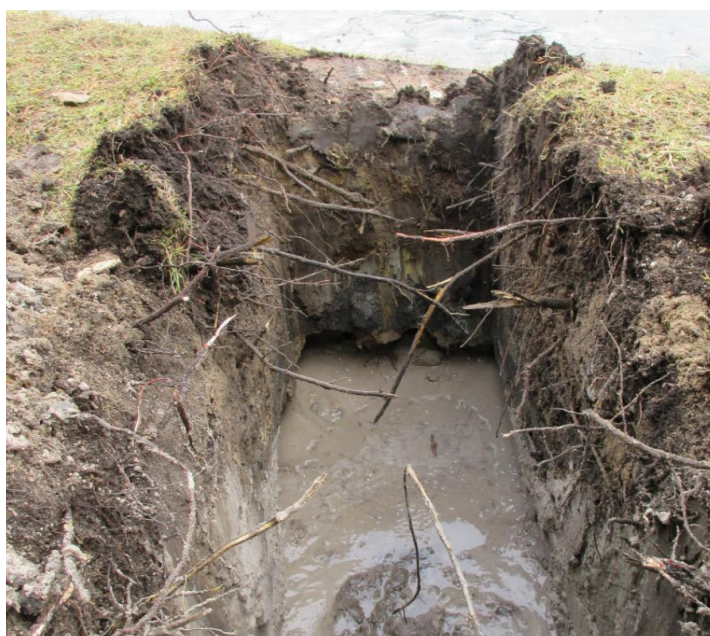
zvodnělé písky, pod humózní vrstvou je patrné jílové těsnění
