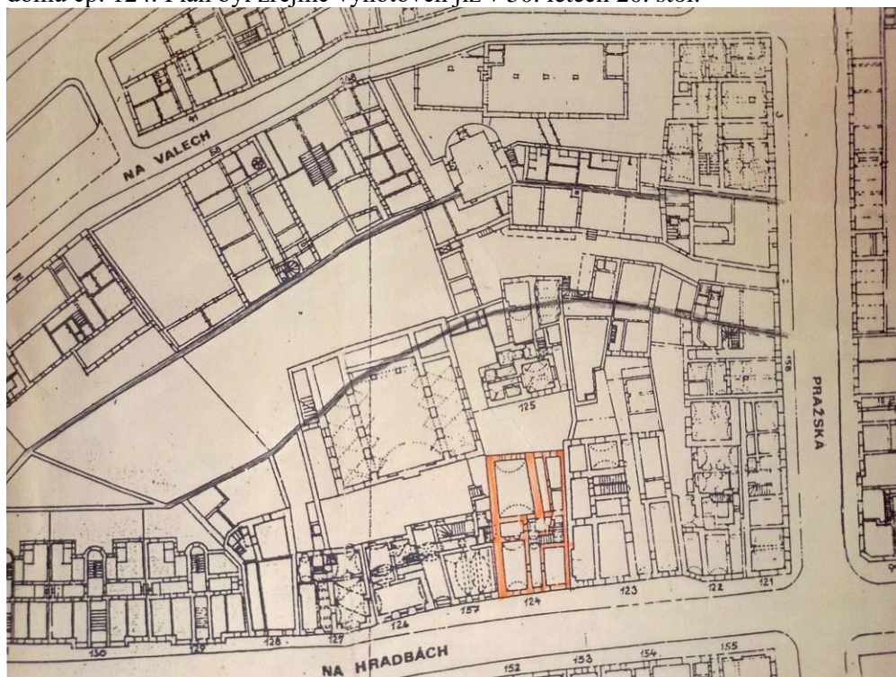
04 , půdorysný plán bloku s vyznačením tmavou barvou předpokládaným průběhem hradeb.
