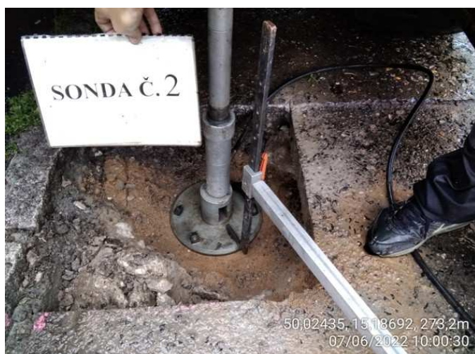
Sonda S2 – měření únosnosti pláně
