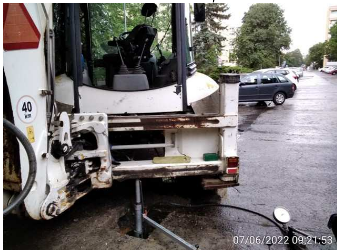
Sonda S1 – měření únosnosti pláně
