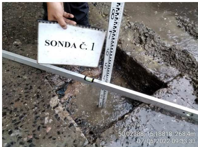
Sonda S1 – měření únosnosti pláně
