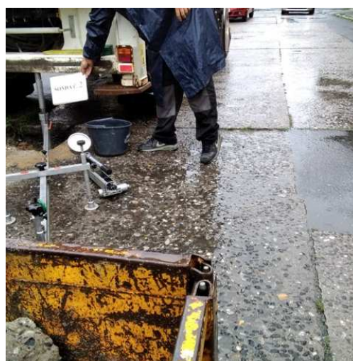
Sonda S2 – měření únosnosti pláně
